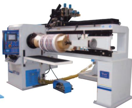
ROBOT PARA BOBINADO AUTOMATIZADO
