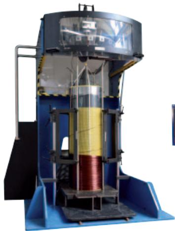
ROBOT PARA BOBINADO VERTICAL
