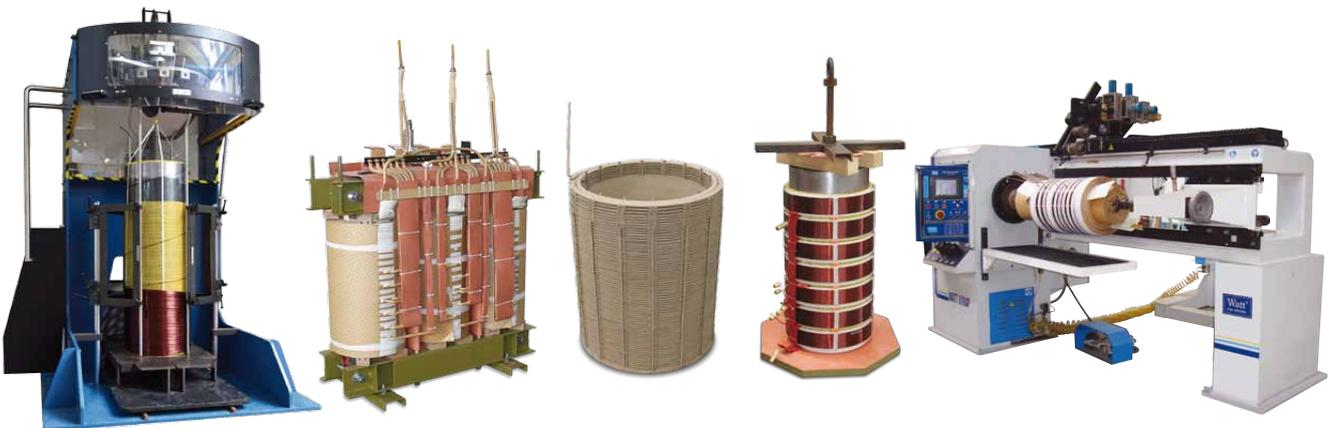
Utilizamos tecnología francesa de última generación para el llenado y secado al vacío. Las bobinas y el núcleo completamente ensamblados, son secados al vacío e inmediatamente después impregnados en aceite dieléctrico.
