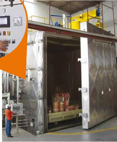
Horno de secado y llenado al vacío.
